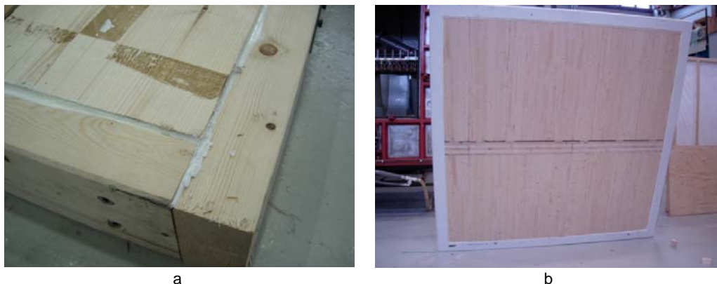
Fig 4.1 Prøvefeldet montert i en ramme med kantbjelker med dimensjon 48 mm x 98 mm (a). Prøvefeldet ble satt inn i en stålramme som ble montert mot luftskapet (b).
