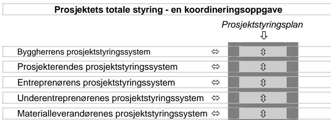
Figur 22. På grunnlag av sitt interne prosjektstyringssystem utarbeider hver deltaker (basisorganisasjon) sin egen prosjektstyringsplan (lys skygge i figuren). Alle planene må samordnes til en samlet felles plan (mørk skygge i figuren).
