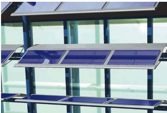
Figur 12 Lameller med integrerte solcellepaneler som en egen fasade utenfor den egentlige fasaden. Lamellene skal dels avskjerme solvarmen, og dels lede sollys inn i bygningen for å erstatte kunstig belysning.
