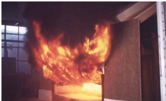
Figur 5.3.3 Fra brannforsøk. Bildet viser flammepåkjenningen ved takfot
