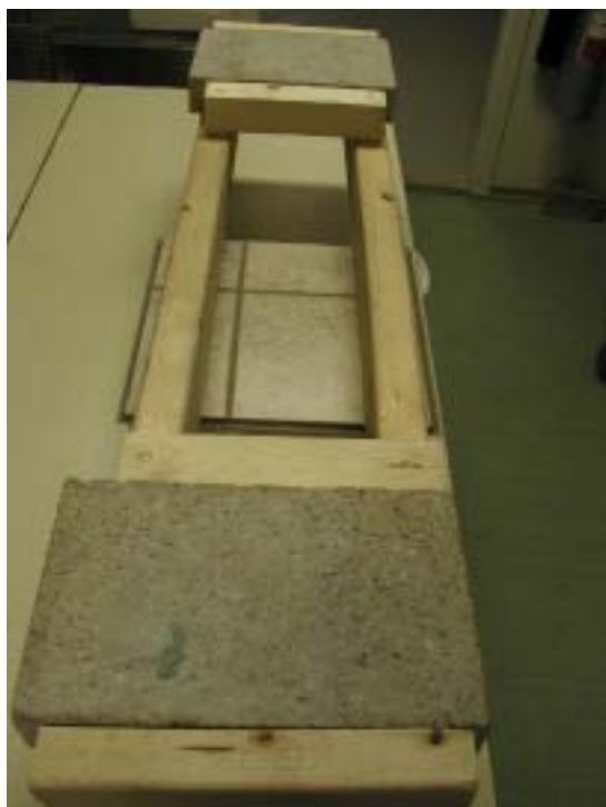
Presskonstruksjonen i tre og stein. Den veide 16,5 kg og hadde en langsgående åpning på 20 cm mellom treverket. Under presskonstruksjonen ser vi ei flislagt trefiberplate på 30 x 30 cm.
